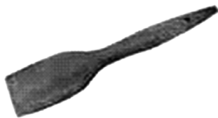
2.38-rasm. Bochkalarni tozalash uchun lopatkalar.
