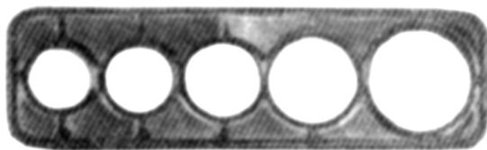
2.47-rasm. Limonlar kalibrovkasi uchun plastmassali shablon.
