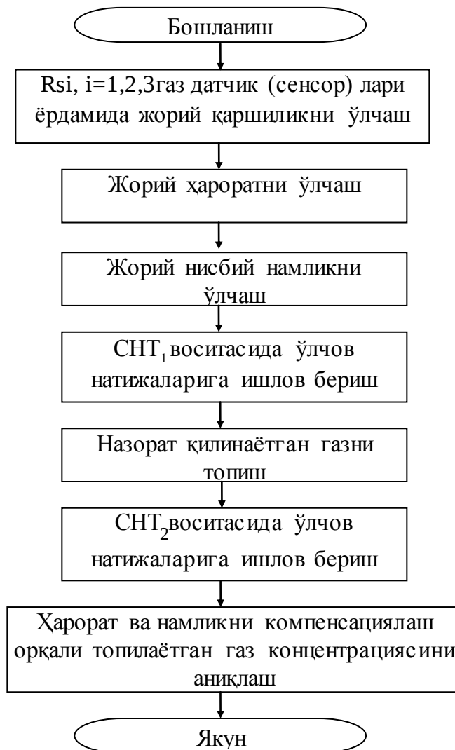
3.7-расм. СНТ асосида муҳит ҳарорати ва намлигининг ўлчовизими кўрсаткичларига таъсирини компенсациялаш орқали газларни топиш ва концентрациясини ўлчаш
