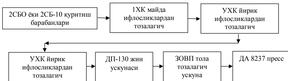
1.1-расм. Жарқўрғон пахта тозалаш корхонасининг технологик жараён кетма-кетлиги.
