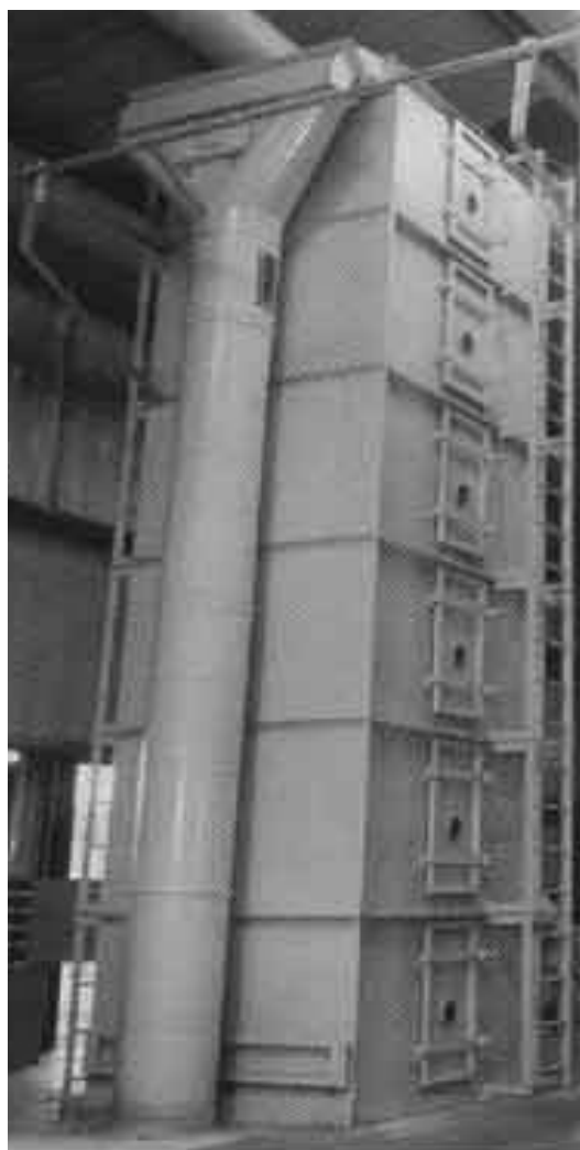
11.9-rasm. Minorali quritgichni tashqi ko'rinishi va texnologik sxemasi
