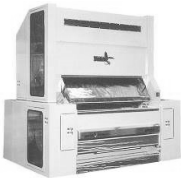
11.14-rasm. Arrali jinlar o'rnatilgan qatorning umumiy ko'rinishi
