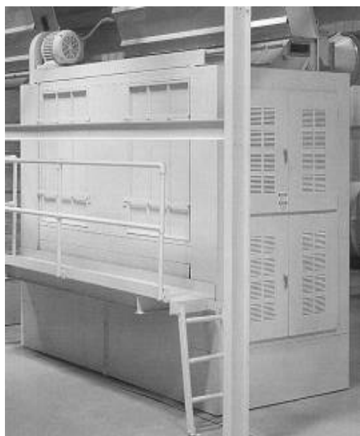
11.12-rasm. Super-III rusumli tozalagichning tashqi ko‘rinishi va texnologik sxemasi.
