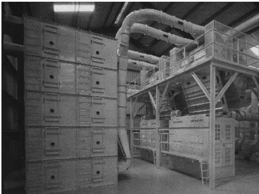
11.6-rasm. Chigitli paxtani quritish va tozalash uskunalarining bo'lim ichidagi umumiy ko'rinishi
