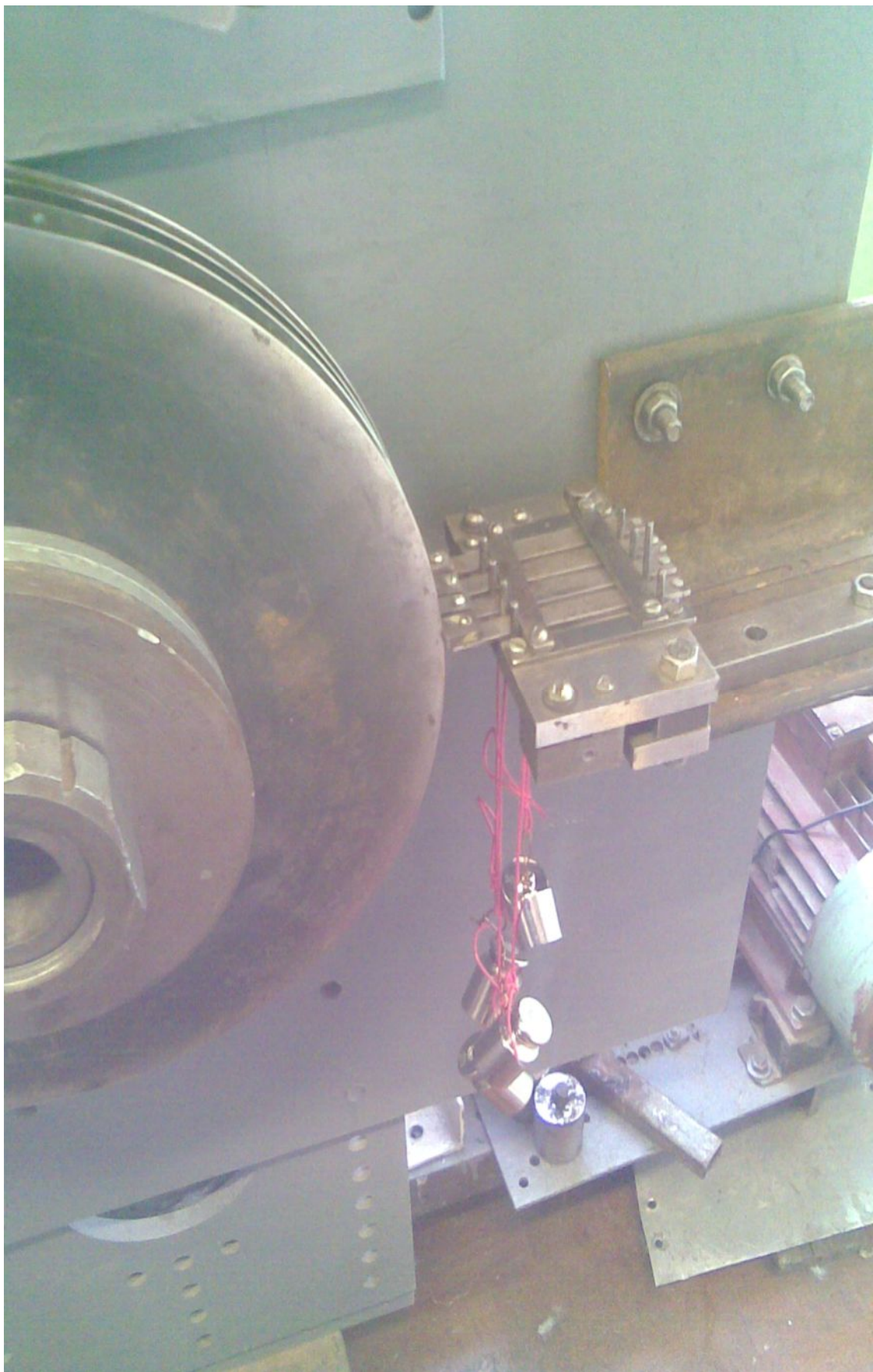
15-расм. Алмашувчан элементларни ейилишга текшириш қурилмаси
