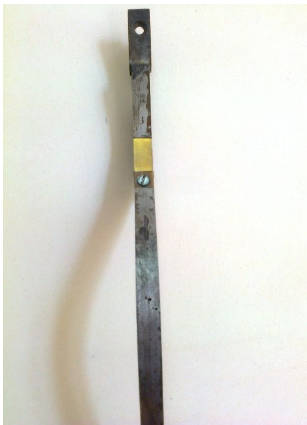
25-расм. Янги конструкциядаги алмашувчан нитроцементланган пластинка
