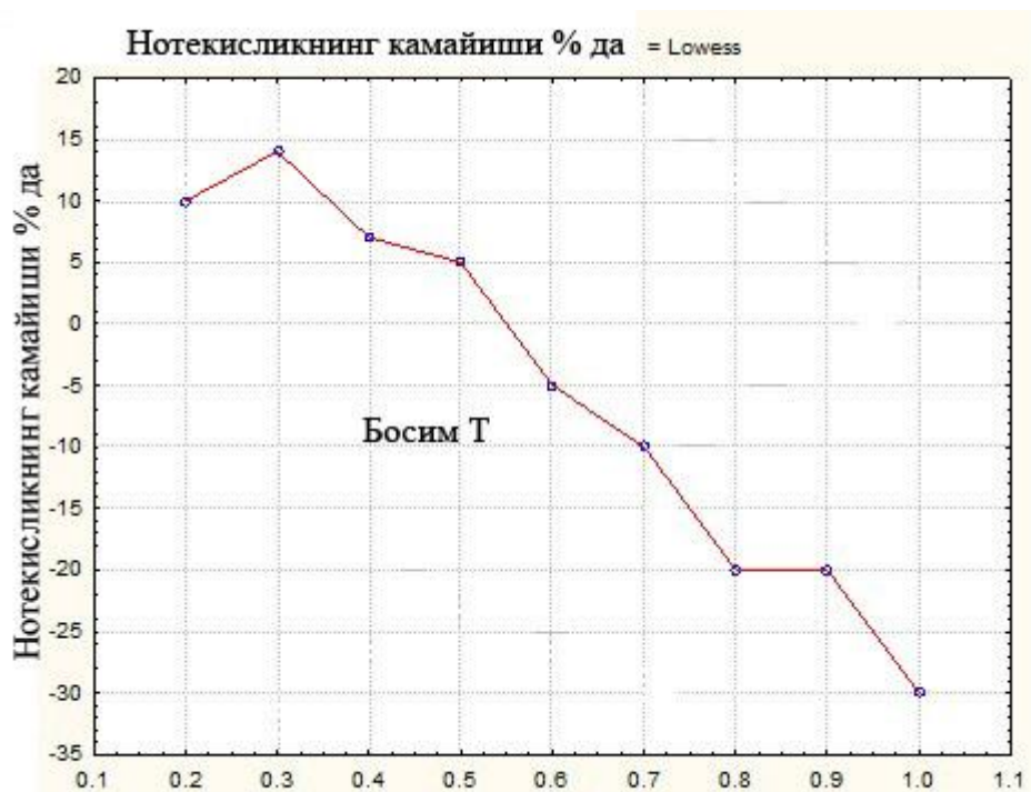
3.6-расм.Рифлончан валцда юкланиш ва нотекисликни камайиш орасидаги боғланиш, процентда
