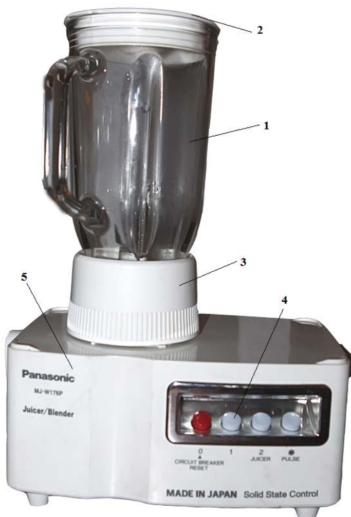
3.2-расм. Лабораторияда ишлатиладиган гидромайдалагич аппарати: 1 – сиғим; 2 – қопқоқ; 3 – майдаловчи металл паррак ёрдамида майдаловчи пластмассали ўриндик; 4 – ҳар хил тезликка ўтказувчи бошқарув тугмачалари; 5 – аппарат асоси.
