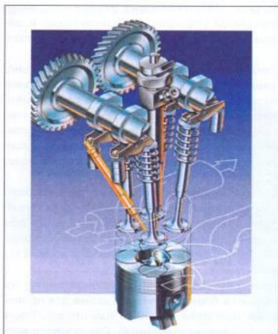
11-rasm. 4 klapanli (a) va 3 klapanli (b) gaz taqsimlash mexanizmlari.
