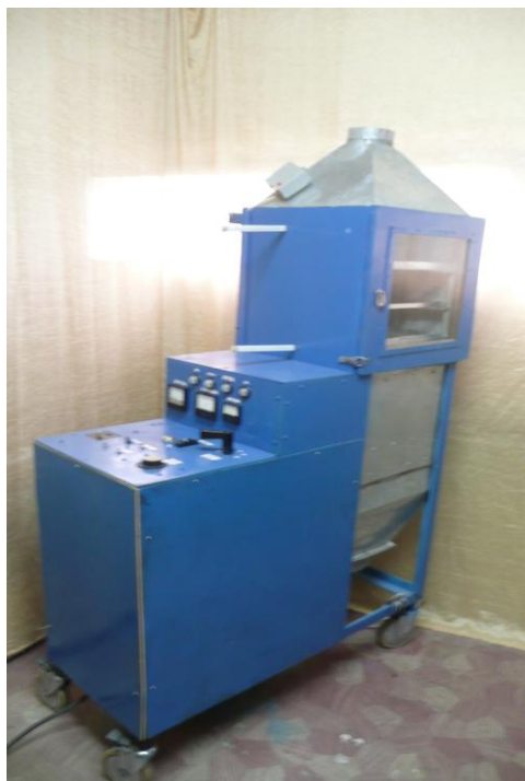
4.10-расм. Қуритиш агентини ионлаштириб қуритувчи қурилманинг тажриба нусхаси кўриниши.
