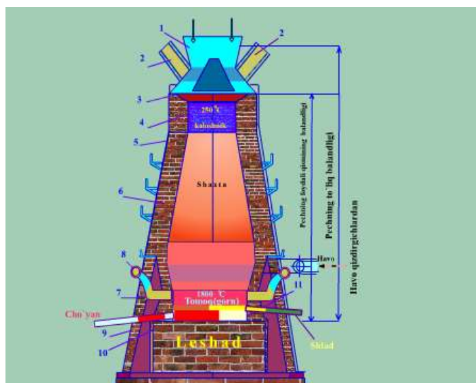
48-rasm. Domna pechining kesimi.
