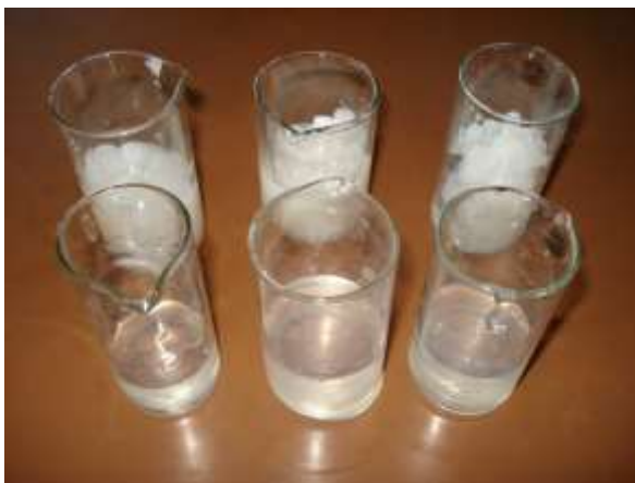
3.7-расм. Гуруч крахмалининг (мос равишда 5,6,7 % ли клейстерлардан олинган) оксидланган (пастки катор) ва натив (юкори катор) совутилган гидрогеллари.
