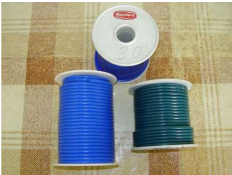
94-расм. Қуйиш тизимини ҳосил қилувчи мумлар.
