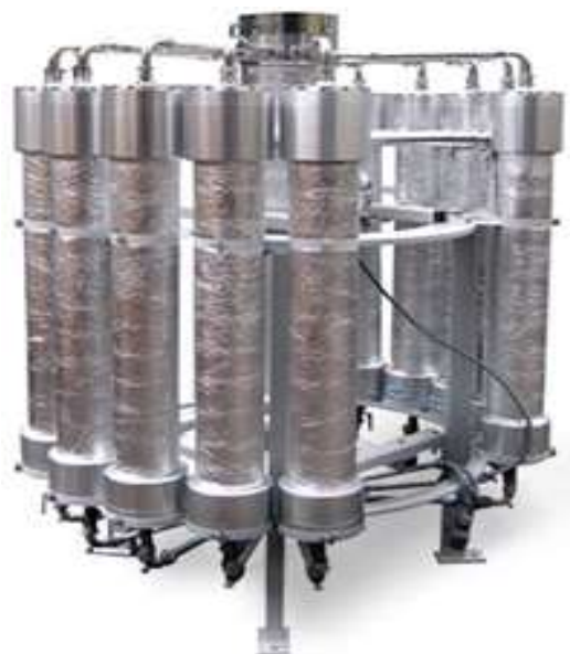
2.7-rasm. Membranali gaz taqsimlash qurilmasi.
