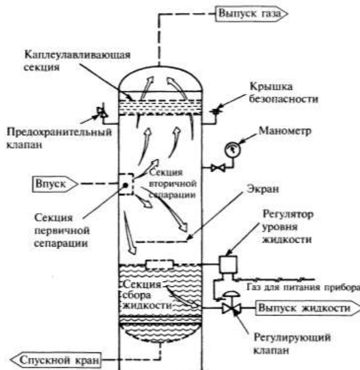
Рам – 15.6. Икки фазали вертикал газсепаратор
