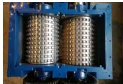
5-rasm. Ikki valikli maydalagich.6-rasm. Zamonaviy ikki valikli maydalagich
