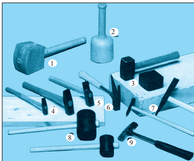
Расми 13. Болғаҳои челонгарӣ ва болғаи ҷӯбин: 1,2 – болғаҳои ҷӯбин; 2, 4, 5, 6, 7 – болғаҳои фӯлодин, 8–9 болғаҳои пластикӣ (чандирӣ).
