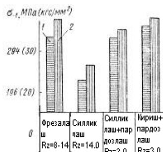
9.6-rasm. Ishlov berish no-tekisliklari 2X13 po'latdan tayyorlangan tekis detallarni egishdagi chidamlilik chegarasiga ta'siri: 1-notekisliklar detal uzunligiga ko'ndalang joylashgan; 2-notekisliklar detal uzunligi bo'yicha joylashgan
