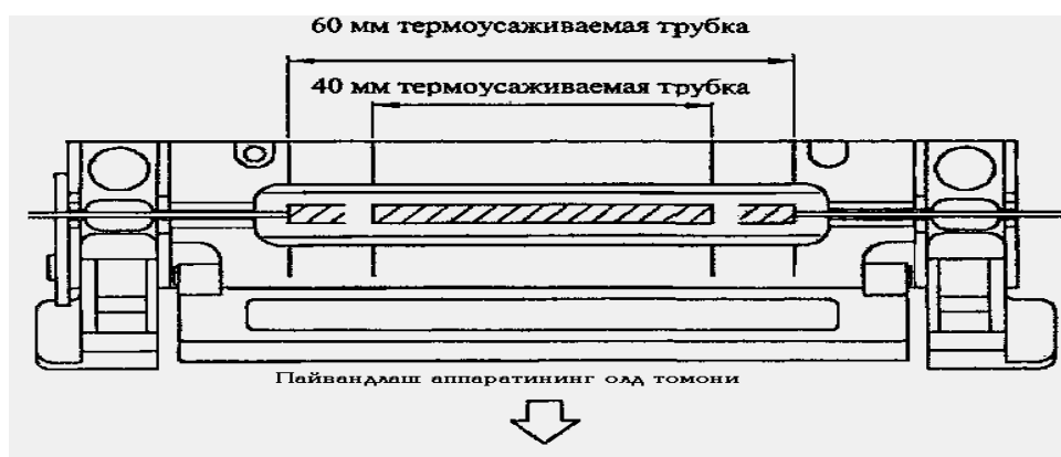
1.15-Расм. Термо сиқилувчи гильзани пайвандлаш аппаратида жойлашиши (юқоридан кўриниш).
