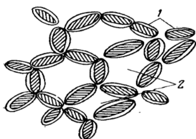
44 -расм. Лахтанинг фазовий тўри. заррачаларнинг иссиқлик ҳисобига 1-дисперс фаза заррачалари; 2- ҳаракатланиши секинлашади ва минерал дисперс муҳитли структура сиртмоғи.
