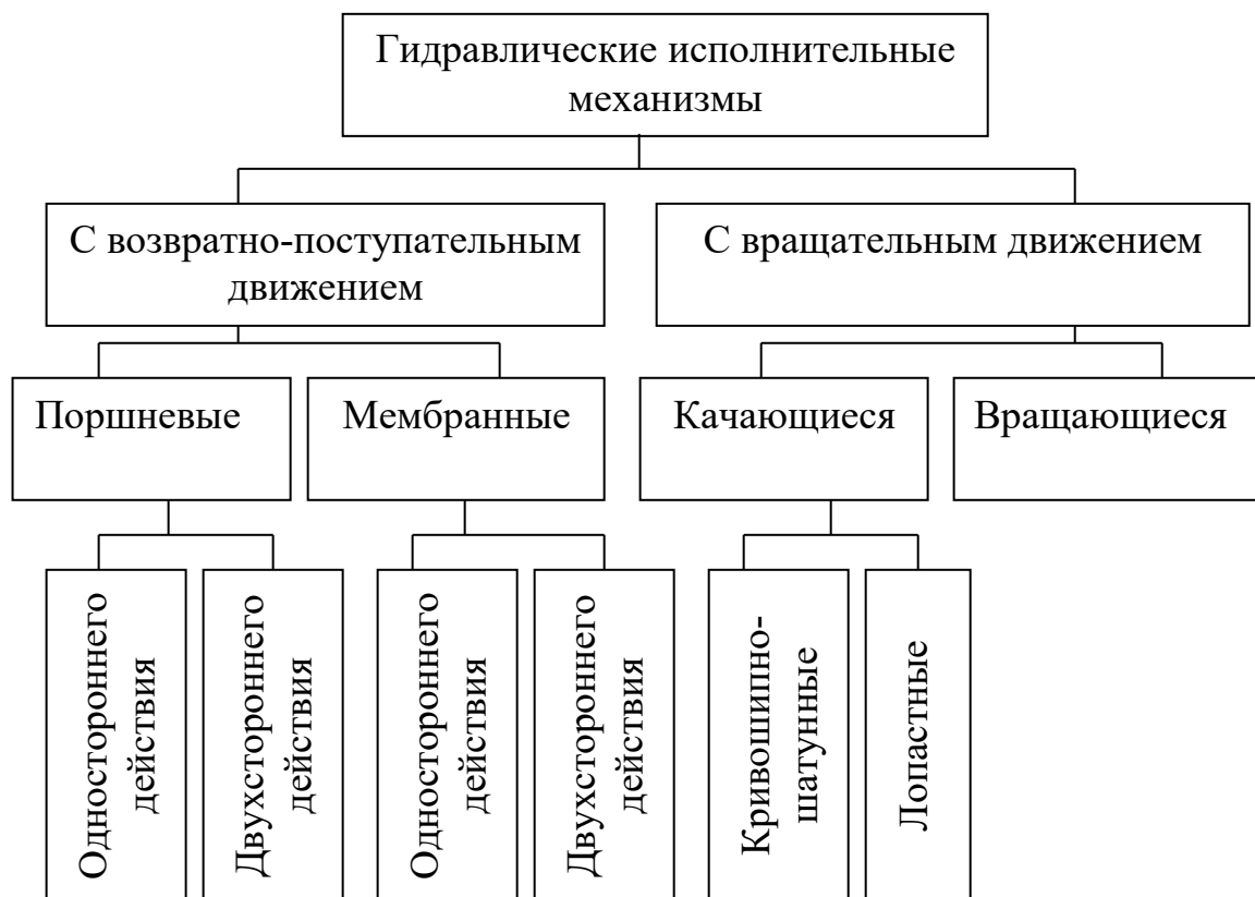
Рис.5.3. Классификация гидравлических исполнительных механизмов
