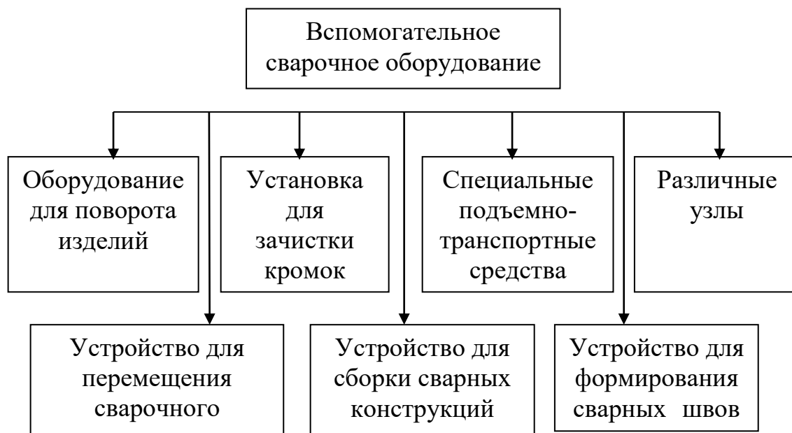
Рис.10.2. Классификация вспомогательного сварочного оборудования
