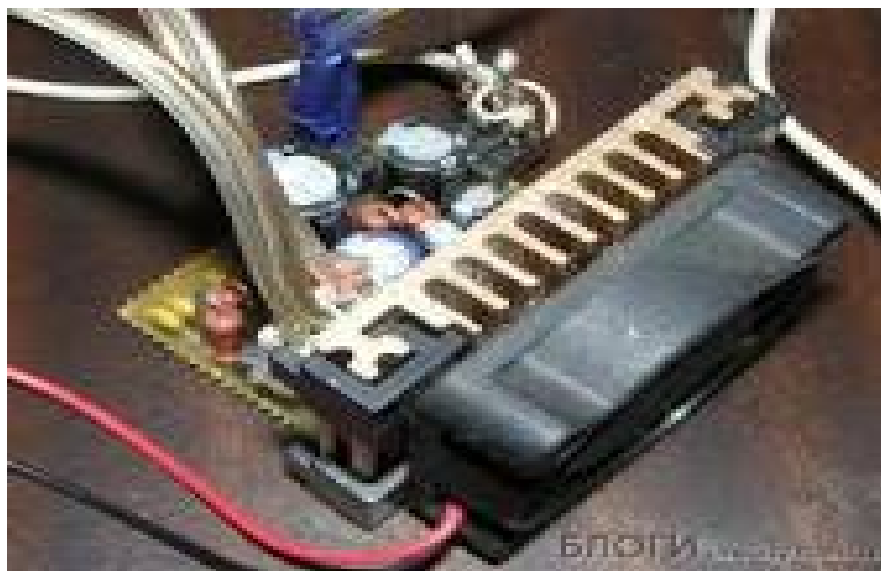
14 – rasm. Tranzistorli ovoz kuchaytirgich
