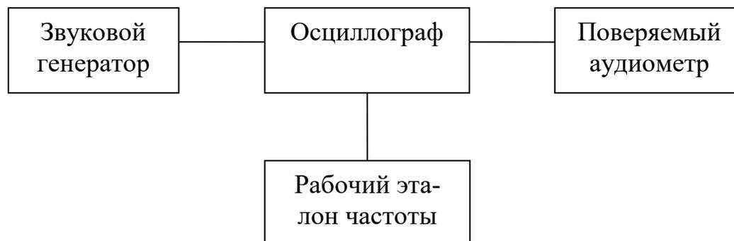
Рис. 2.18. Блок-схема установки для проверки аудиометров
