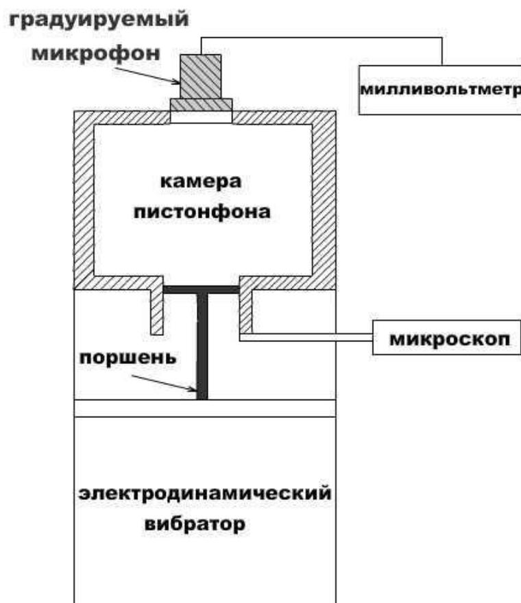
Рис. 4.5. Схематическое устройство пистонфона
