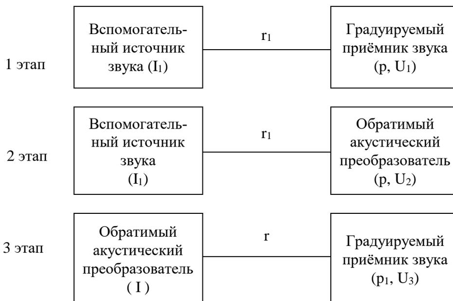
Рис. 4.1. Градуировка приемников звукового давления методом взаимности в свободном поле
