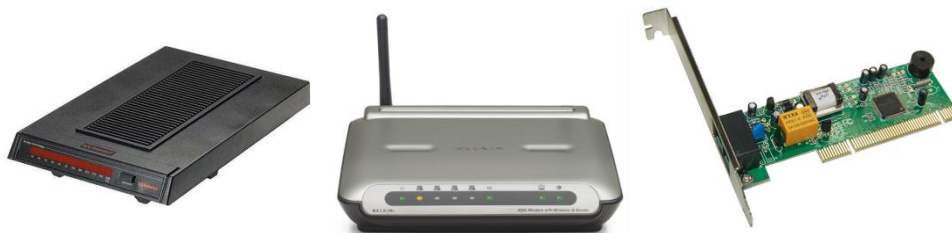
1.11-rasm. Tashqi faks modemi, simsiz modem va ichgi modemlar
