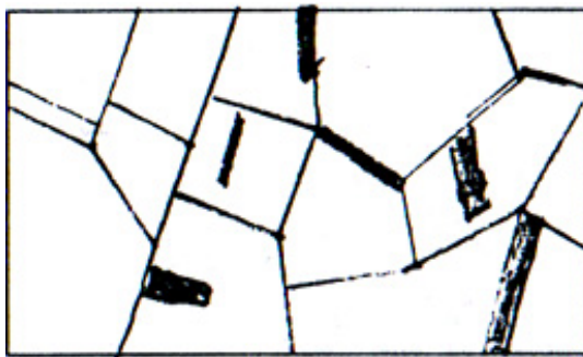
36-сүүрет. Деформацияланған хәм жумсартылған қалайылы бронзаның микроструктурасы
