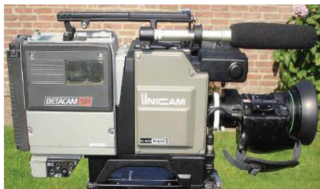
Камкордер Ikegami Unicam HL-99A формата Betacam SP
