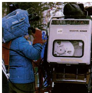
Видеосистема Bosch Fernseh КСА-РК9: камера КСА-90 и переносной магнитофон BCN 20 формата В (1980 год)
