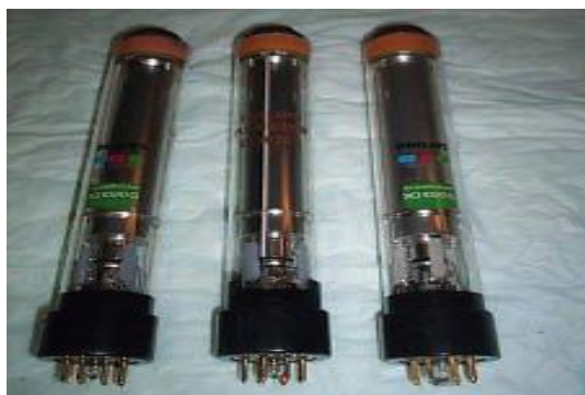
Плюмбиконы, которые использовались в камерах Bosch Fernseh
