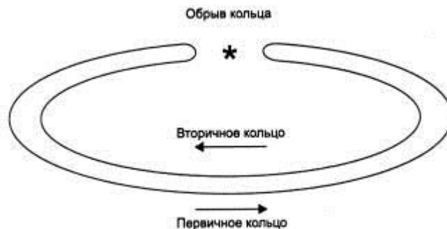
8.1.- расм. FDDI тармоғида носозлик пайтида ҳалқаларни реконфигурациялаш.
