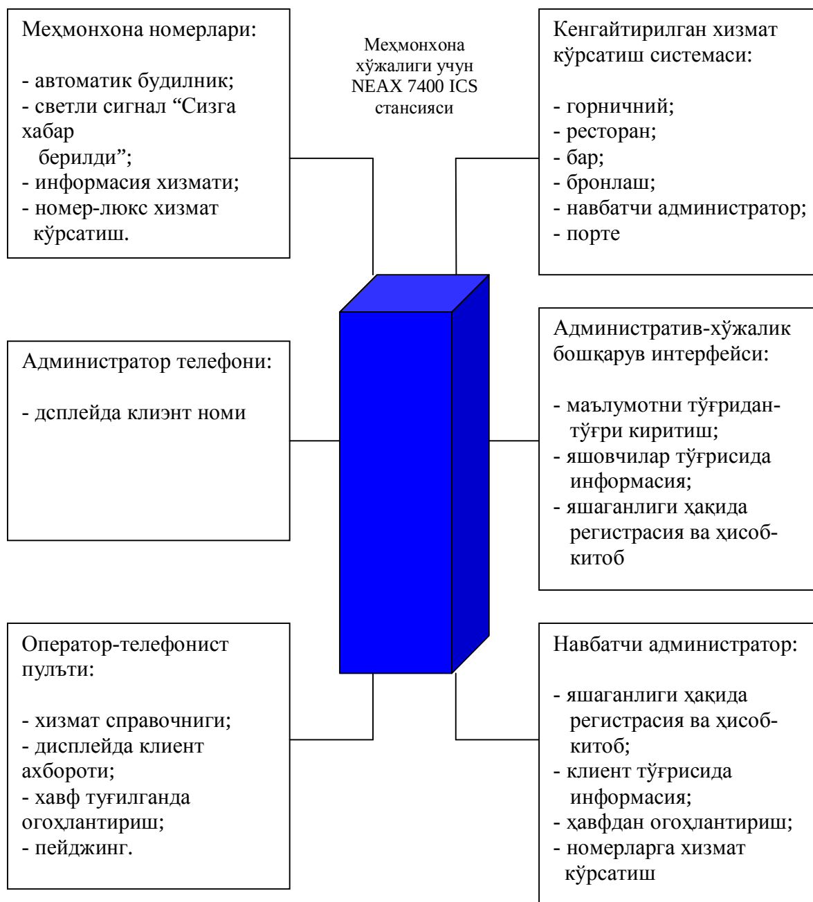
Расм-5.1. Millenium NEAX7400ICS мисолида меҳмонхона учун станция схемаси.
