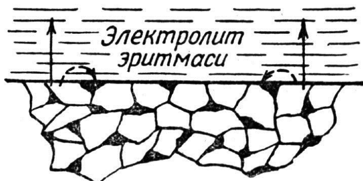
42- расм. Электрохимёвий коррозия
