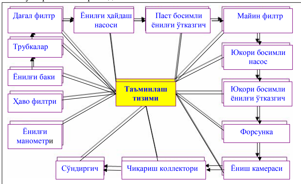
3.1-расм. Дизел двигателини таъминлаш тизимини тузилиши бўйича кластер
