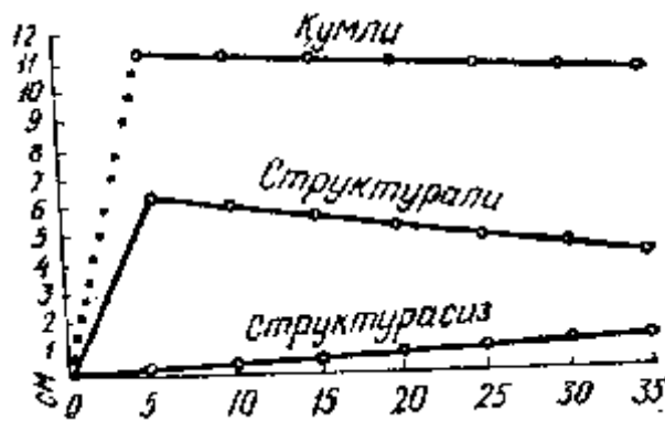
9-rasm. Qumli, strukturali va strukturasiz tuproqlarning suv o'tkazuvchanlik xossasini ko'rsatuvchi diagramma.
