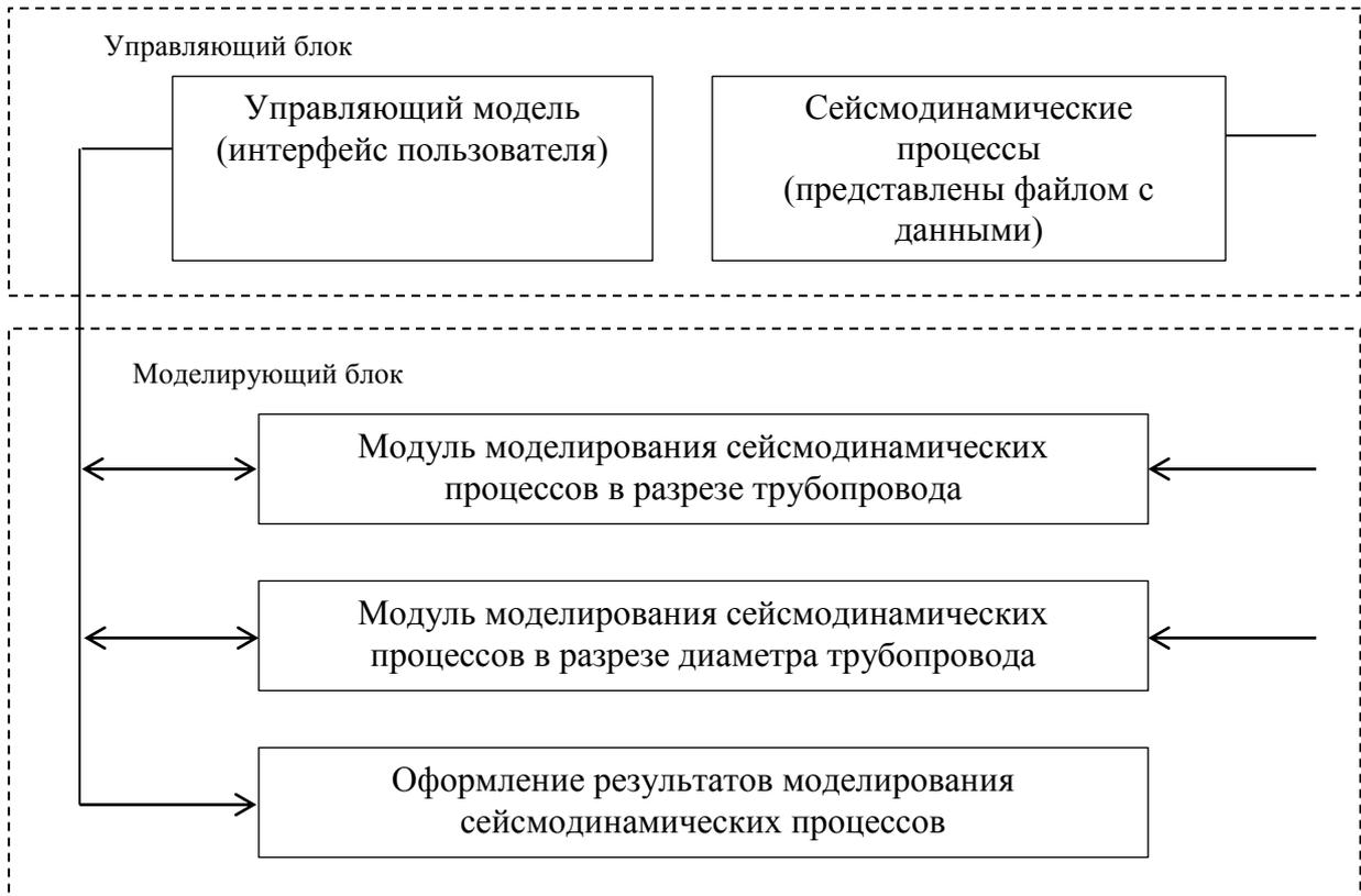
Рис. 2.4.1. Описание программного моделирующего комплекса сейсродинамических процессов
