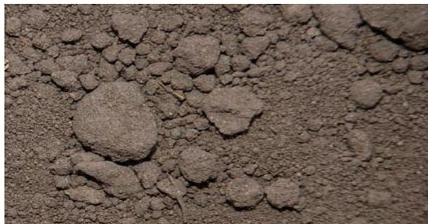
Рис.2.2.2. Грунт крупнообломочного типа
