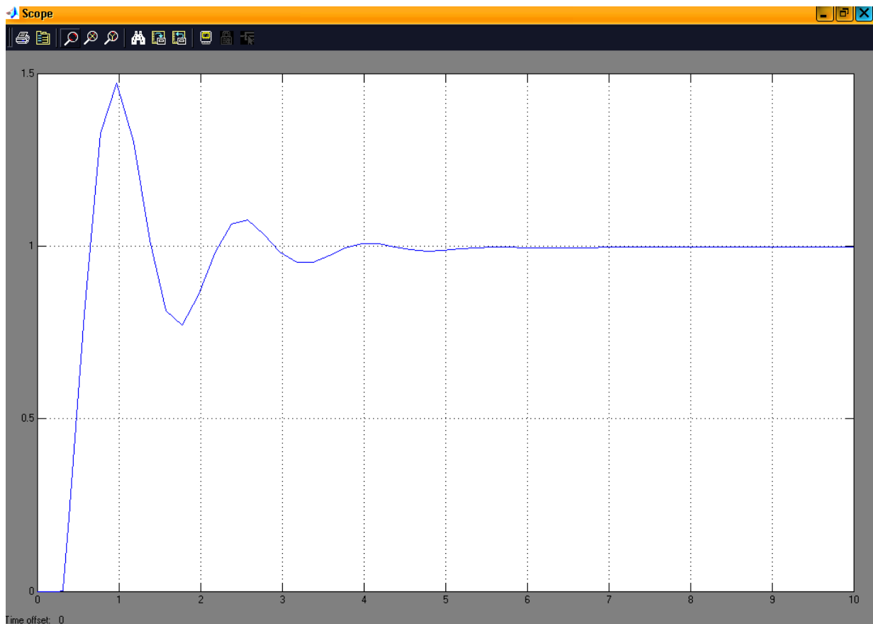
Рис.6. Переходной процесс по заданию (при \min f )
