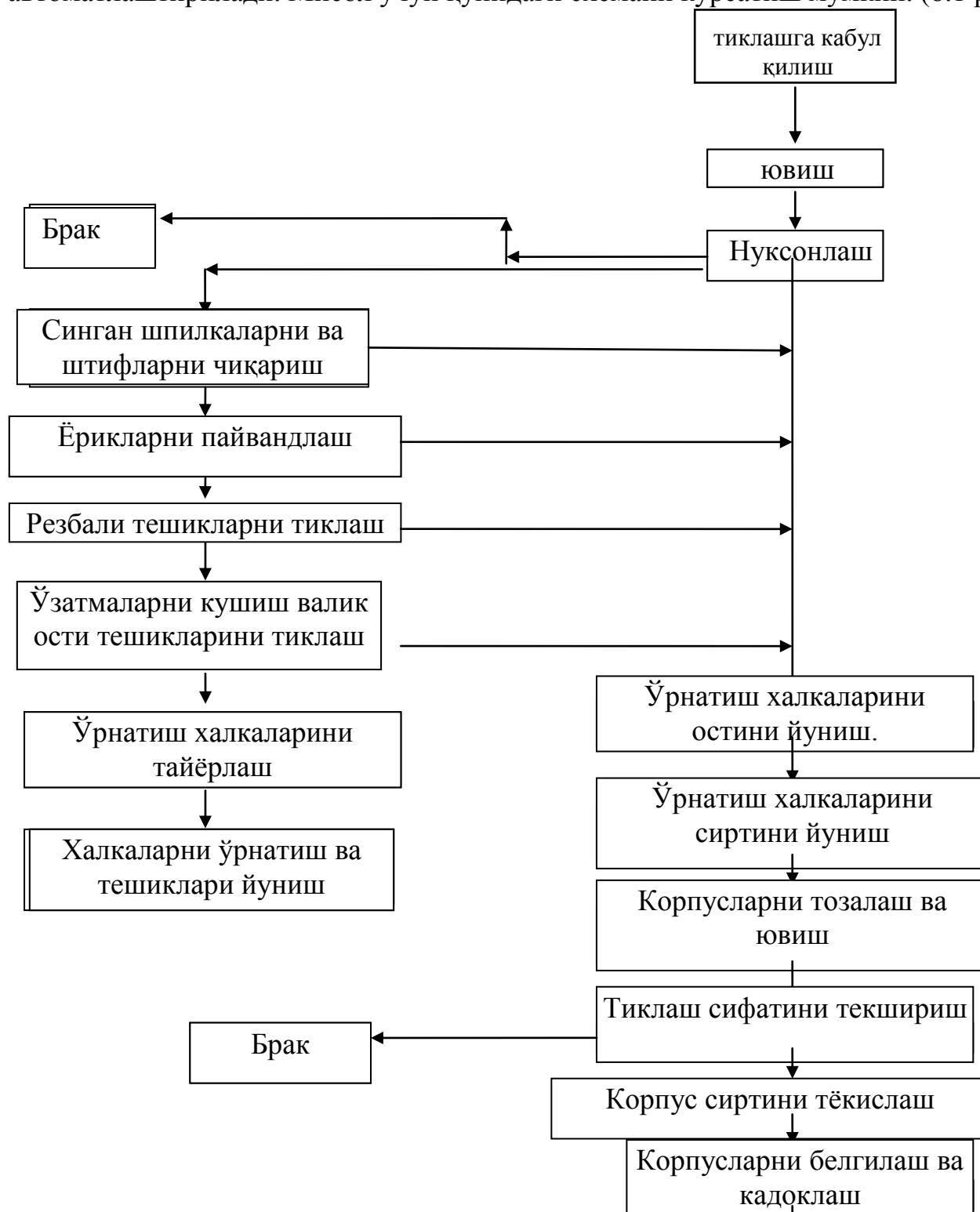
8.1-расм. Механизациялаштирилган поток усулида тракторларнинг ўзатмалар куттиси корпусининг тиклаш технологик схемаси.
