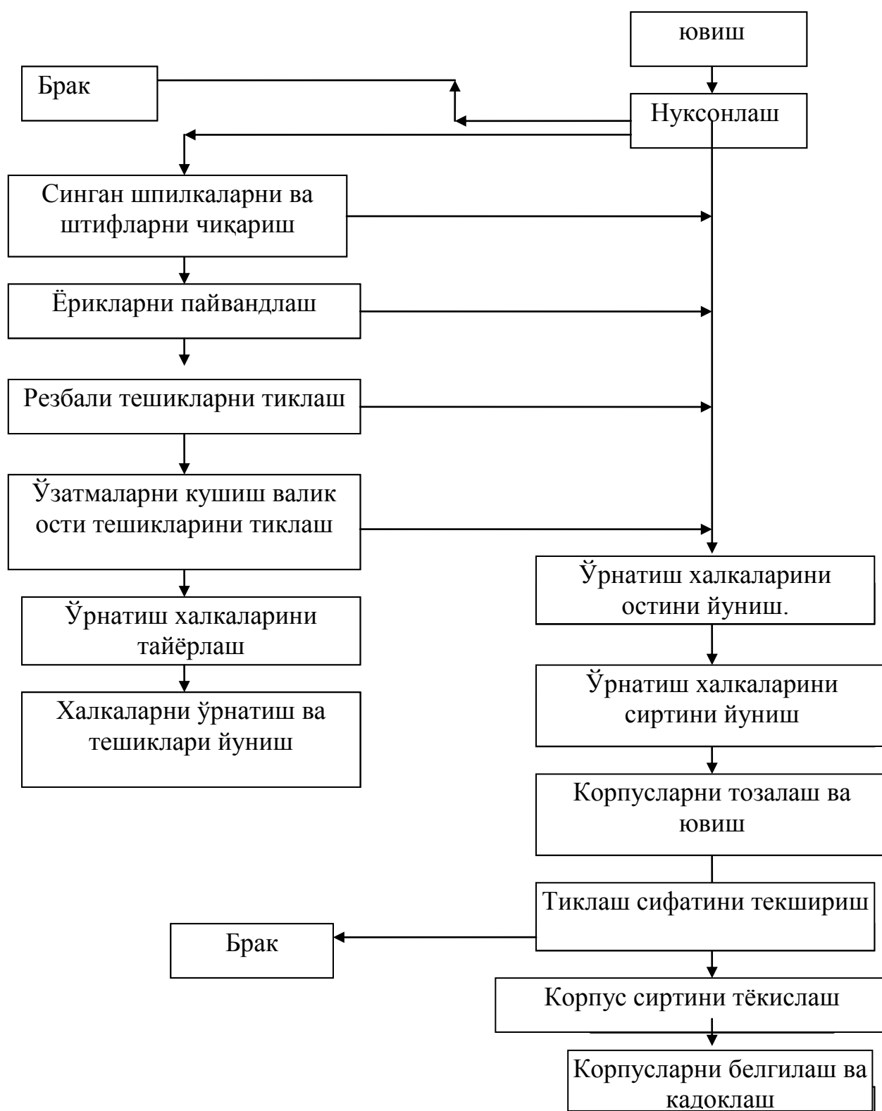
2.8-расм. Механизациялаштирилган поток усулида тракторларнинг ўзатмалар қуттиси корпусини тиклаш технологик схемаси.
