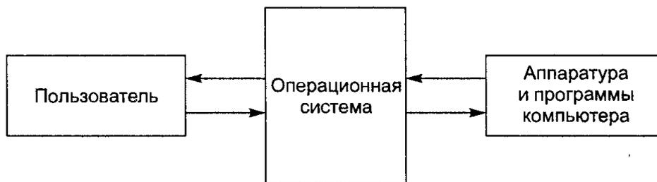
Рис. 3.1. Взаимодействие пользователя с аппаратными и программными средствами компьютера
