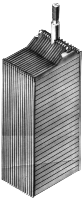
6.5-rasm. TPNJ-550 ishqorli akkumulatorning yarim blok plastinasi.
