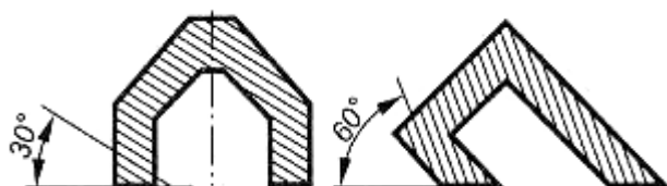
130-shakl. Shtrixlash chiziqlari kontur chizig'i yoki o'q chiziqlariga parallel bo'lsa shtrixlash usuli
