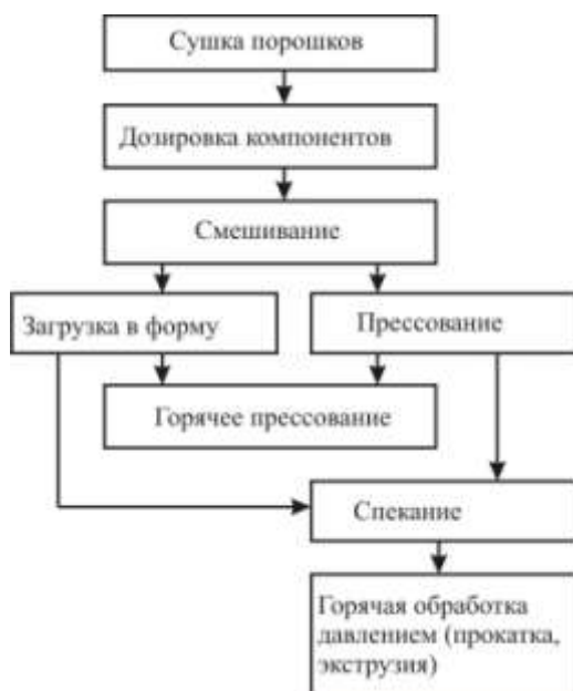
Рисунок 2. Схема получения сплавов на основе никелида титана методами порошковой металлургии [2].
