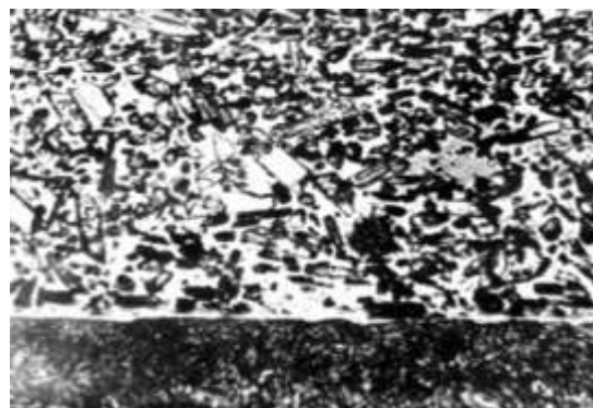
Рис. 2. Микроструктура поперечного разреза детали с наплавленным слоем композиционного порошкового материала (x100)
