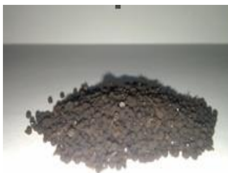
Рис. 4.2. Твердый Са-альгинатный биосорбент на основе биомассы виноградных выжимок.
