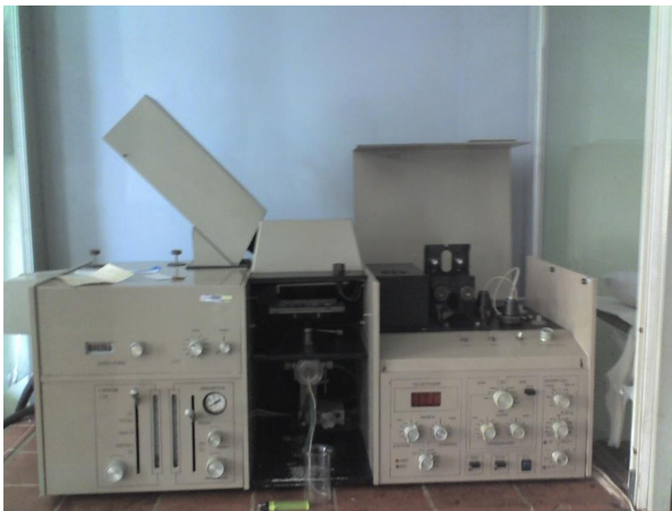
Рис.2.1. Внешний вид атомно-абсорбционного спектрофотометра «Сатурн-1»
