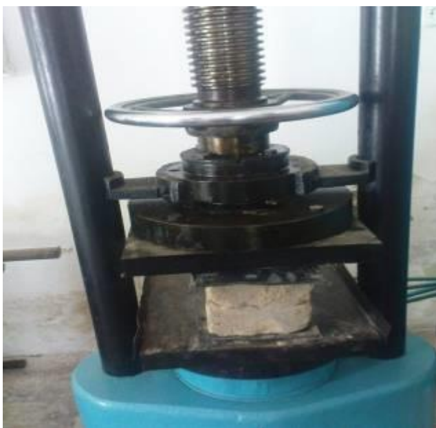
2.3-расм. Хом ғиштни гидравлик пресда мустаҳкамлигини синаш
