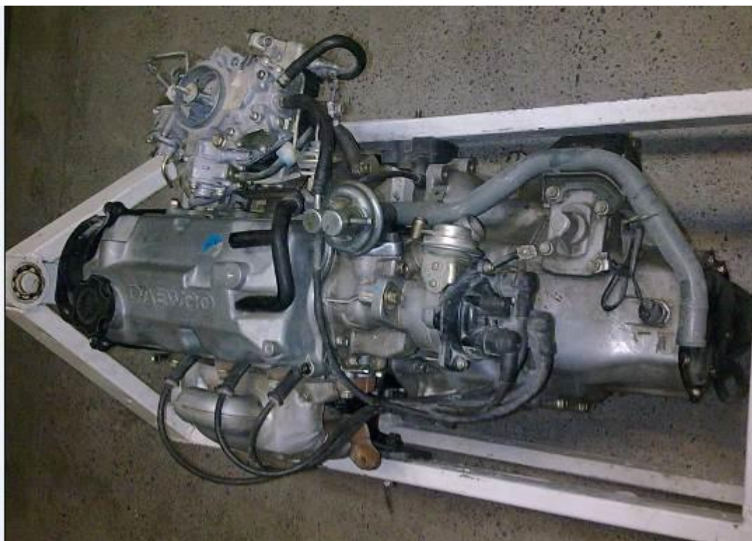
22- расм. “Тико” автомобили двигатели базасидаги аввалги стенд.
