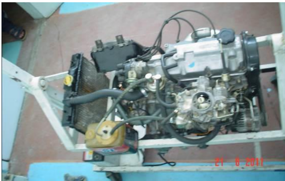
25- расм. “Тико” автомобили двигатели базасидаги стенд. Ортидан кўриниши
