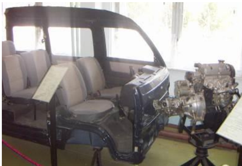
3- расм. Дамас автомобилнинг қирқимли комплекс ўқув станди
