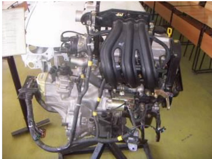
1- расм. Матиз автомобили двигателининг ўқув стенди
