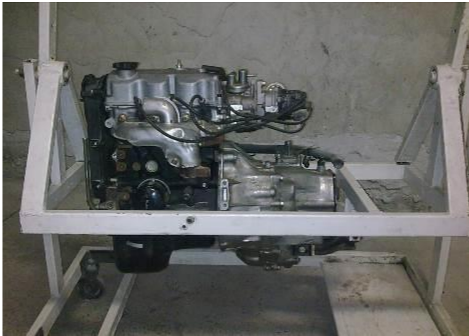
19- расм. “Тико” автомобили двигатели базасидаги аввалги стенд. Ёндан кўриниши
