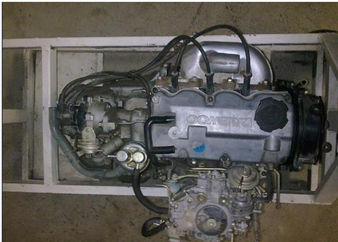
20- расм. “Тико” автомобили двигатели базасидаги аввалги стенд. Юқоридан кўриниши
