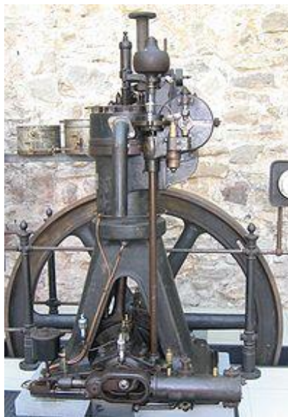
15- расм. Биринчи бир цилиндрли дизелли двигатель
