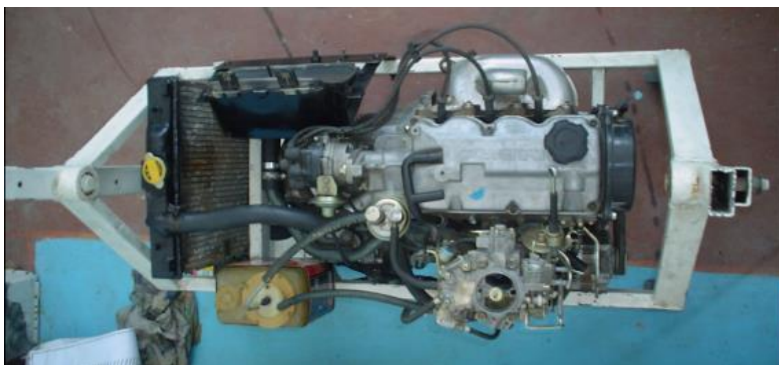
24- расм. “Тико” автомобили двигатели базасидаги стенд. Юқоридан кўриниши
