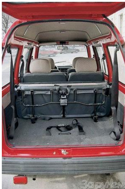
1.3–расм. Daewoo Damas DLX автомобилининг бешинчи эшигининг очилган ва орқа ўриндикнинг йиғилган ҳолати
