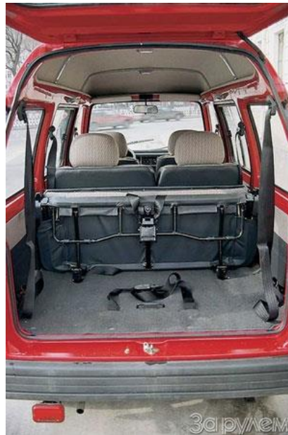
1.3–расм. Daewoo Damas DLX автомобилнинг бешинчи эшигининг очилган ва орқа ўриндикнинг йиғилган ҳолати
