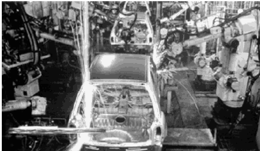
6.1 Elektr bilan payvandlash kompleksi
