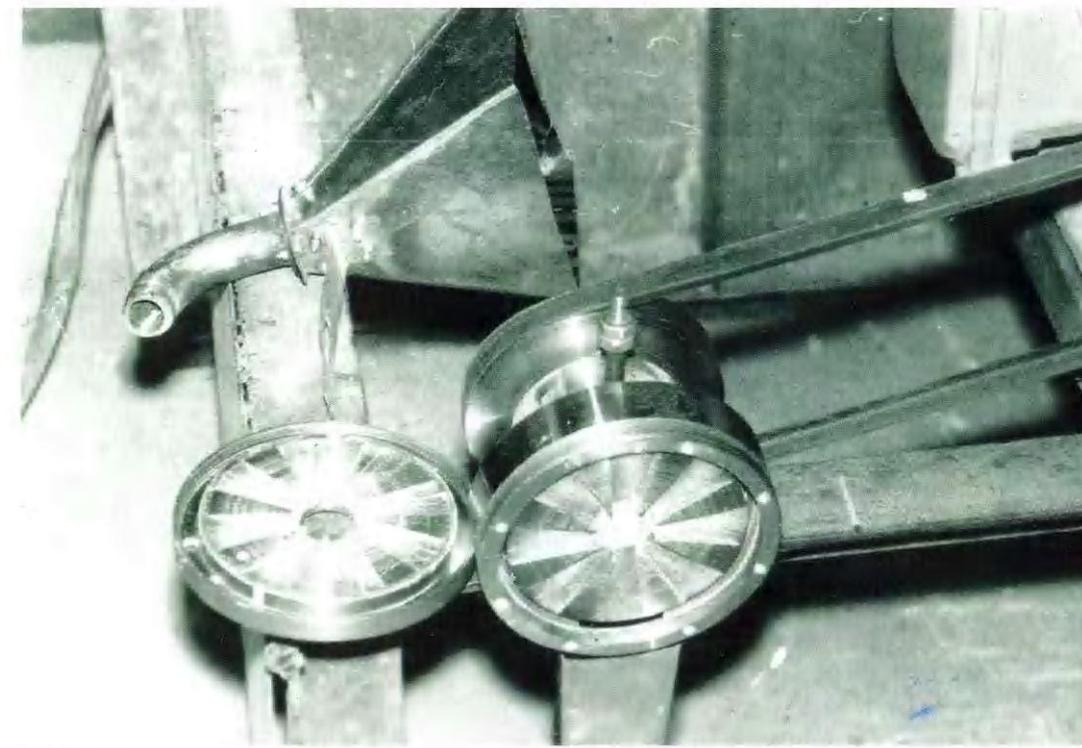
Рис.3.1. Стенд для исследования вертикально-роторной дробилки
