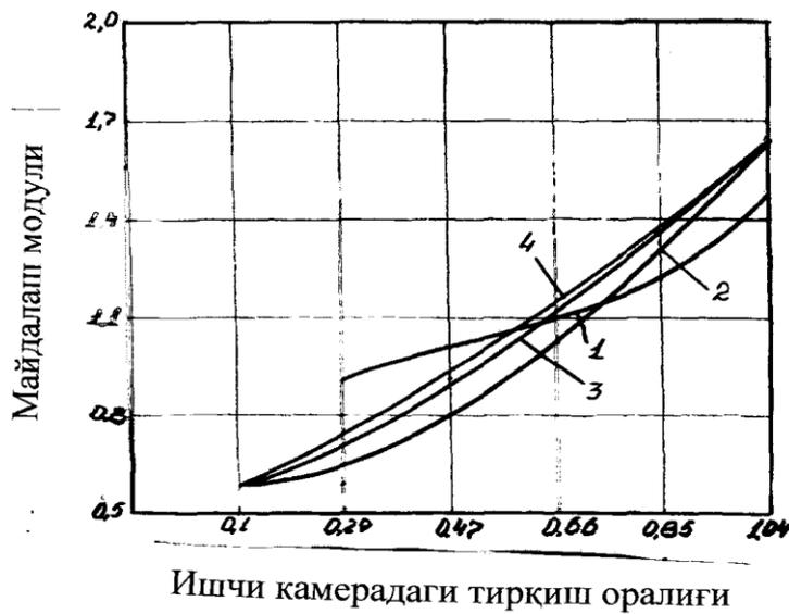
Рис.3.3. Изменение модуля помола в зависимости от величины зазора в рабочей камере:
