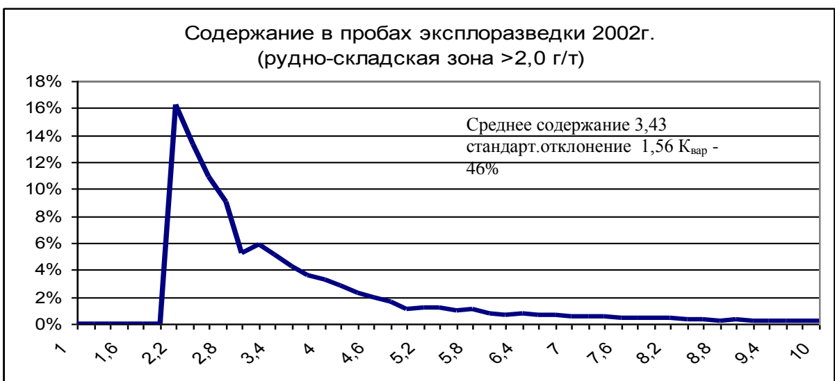
Рис. П.1.8. Распределение содержания металла в пробах эксплоразведки
