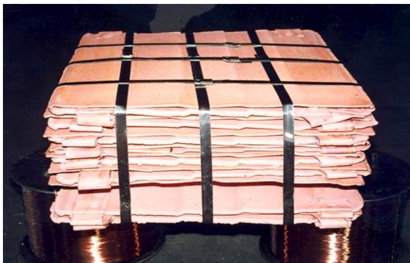
5- расм. Электролиз цехидан чиққан ва сотувга тайёрланган 99,99 % ли маҳсулот – мис катодининг умумий кўриниши.
