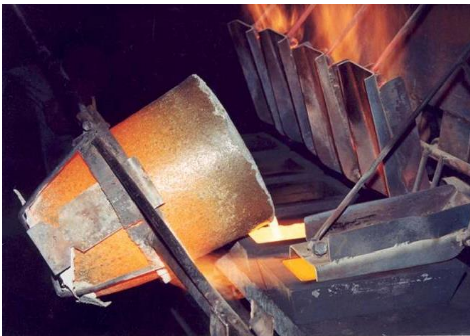
14 -расм. Соф тоза олтин (99,99% ли) қўймасы қолипларга қўйиш жараёни(Олмалиқ мис эритиш заводи).
