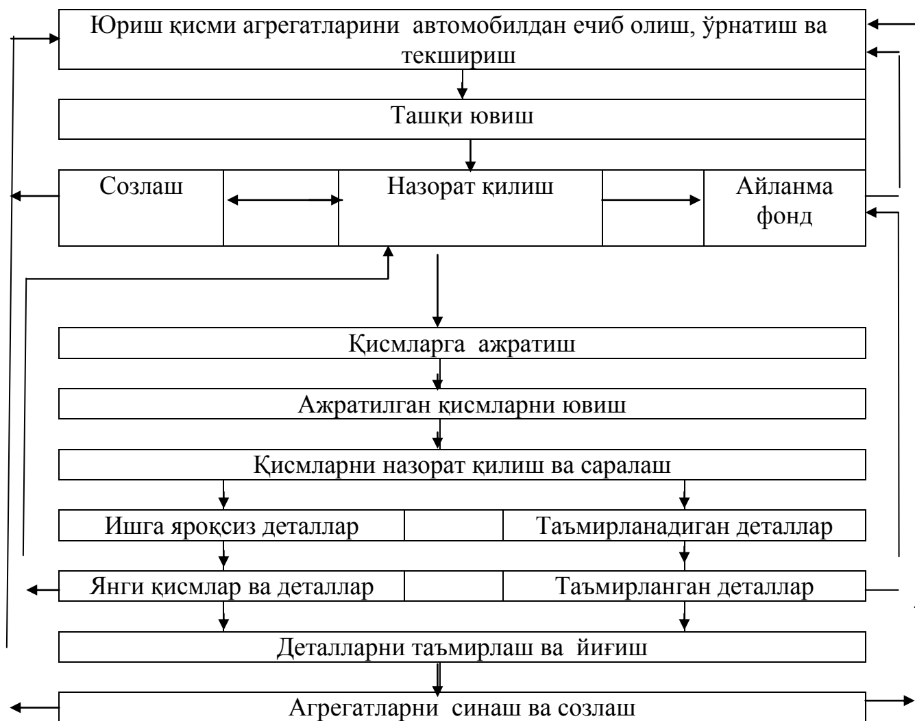
3.1-расм. Юриш қисмига хизмат кўрсатиш ва таъмирлаш стационада юриш қисми агрегатларини таъмирлаш технологик жараёнини ташкил этиш шакли
