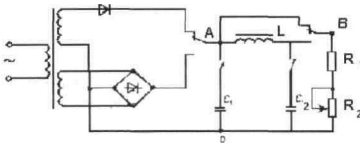
Рис.8. Схема лабораторной установки для исследования выпрямителя.
