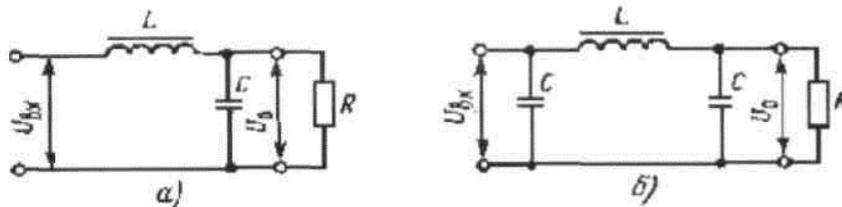
Рис. 7. Г-образная (а) и П-образная (б) схемы сглаживающих фильтров
