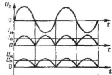
Рис. 6. Диаграммы напряжений и токов в схеме двух-полупериодного выпрямителя
