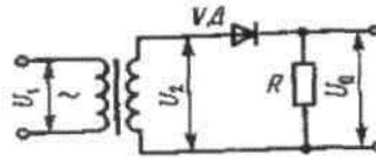
Рис. 3. Схема однополупериодного выпрямителя
