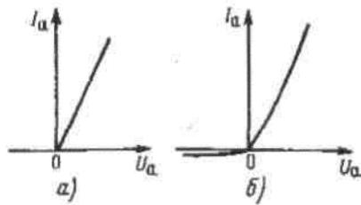
Рис. 2. Идеальная (а) и реальная (б) вольт-амперные характеристики полупроводникового диода
