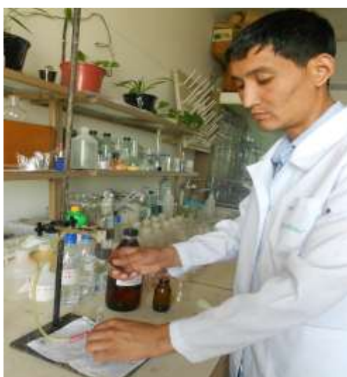
2.3-расм. Сувда нитратларни кадмий метали билан нитритларгача қайтарилиш жараёни
