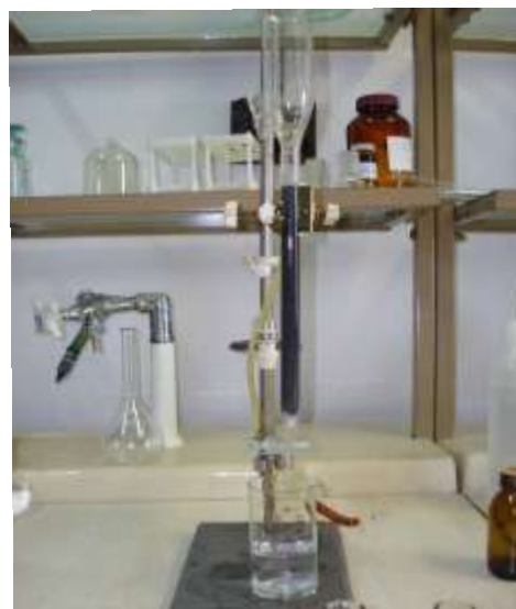
2.3-расм. Сувда нитратларни кадмий метали билан нитритларгача қайтарилиш жараёни
