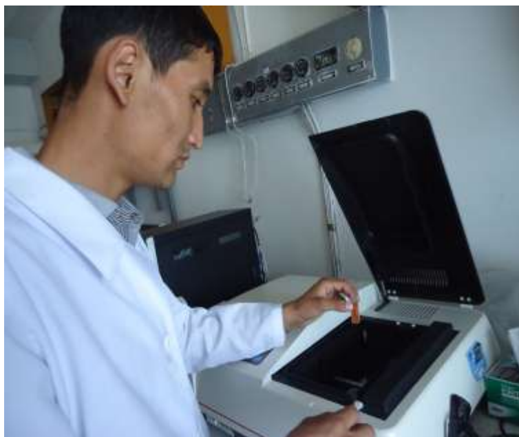
2.2-расм. Сув намунасини спектрофотометрда таҳлил қилиш жараёни
