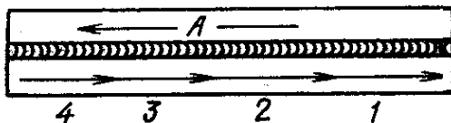
4.12 - rasm. O 'rtacha uzunlikdagi choklarni teskari bosqichli usulda payvandlash (1-4 choklarni payvandlash ketma-ketligi)
